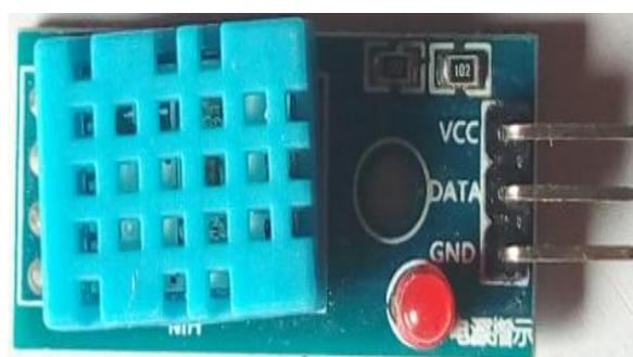
Fig. 2. DHT11 Temperature Sensor
